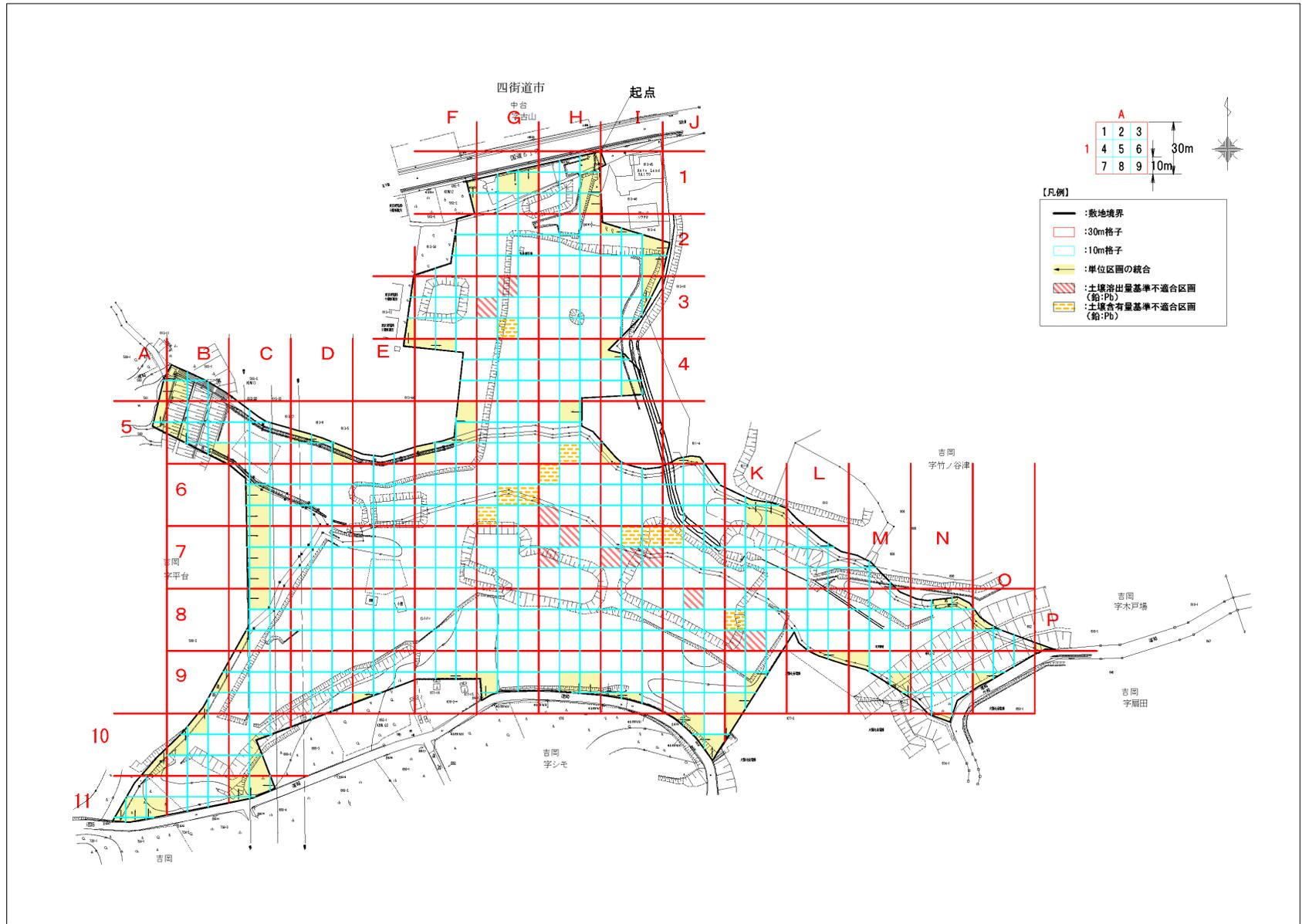
図 2-7 土壌溶出量・含有量基準不適合区画(鉛及びその化合物:状況調査)
