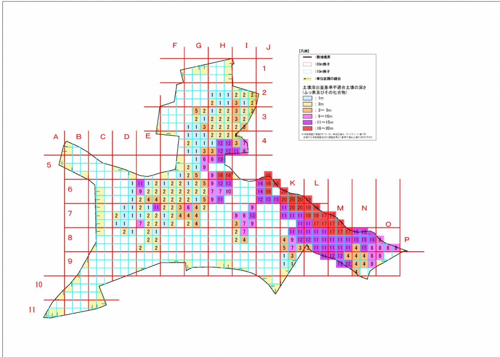
図 2-13 土壌溶出量基準不適合土壌の深さ(ふっ素及びその化合物)
