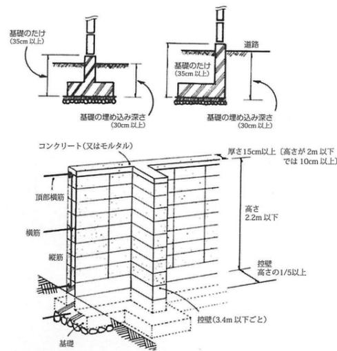
鉄筋の施工方法(左図)(ブロックはJIS製品のこと)
